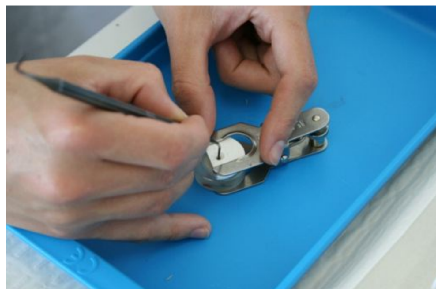
Herstellung standardisierter Kompositproben und adhäsive Befestigung
